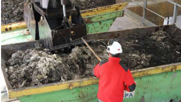
Residuos sólidos indeseados en depuradoras de aguas residuales | Canal de Isabel II
